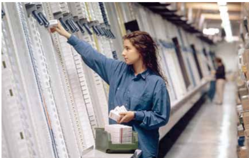
Arbeit am Kommissionierapparat – in den Anzag-Niederlassungen gibt es einen sehr hohen Automatisierungsgrad FOTOS: ANZAG
